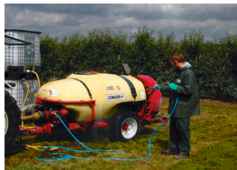
Abb. 2: Aussenreinigung der Gebläsespritze auf der Parzelle. (Foto: Topps)
