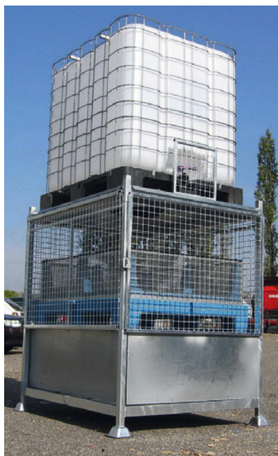
Abb. 4: Physikalische Behandlungssysteme basieren auf dem Verdunsten des Abwassers und dem Rückhalt der PSM-Rückstände in entsprechenden Filtermedien. (Foto: CCD SA)
